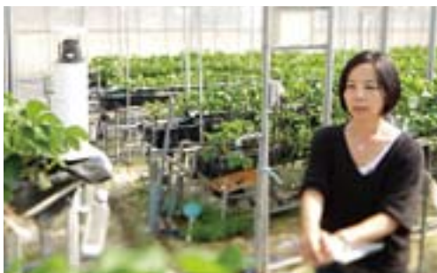
カメラ、温度、湿度、日射などの各種センサを搭載し、農業の見える化を助ける「フィールドサーバ」
