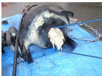
異物が詰まった実際の現場写真
