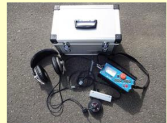
▲漏水調査機器
