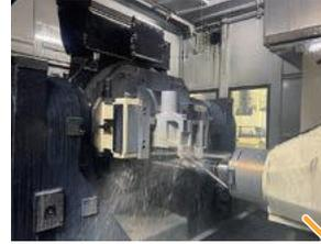
1 部品の表面を切削していきます。形状や材質に合わせて使う機械を変えます。
