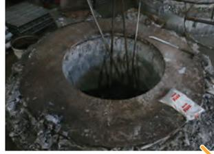
1 アルミニウムのインゴットを高温の「るつぼ」に入れて、ドロドロに溶かします。
