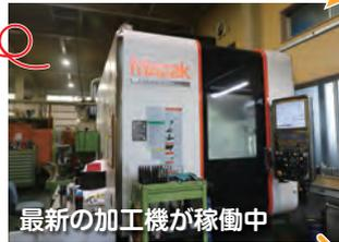
3 精密加工機で製品に穴を開けたり、表面を削ったりする加工を施します。
