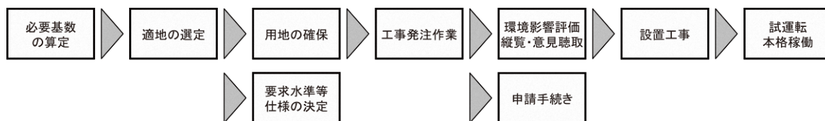
図 4-1-2 仮設焼却炉設置フロー
